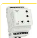
VRU3N-28 Hlídá velikost fázových napětí proti nulovému vodiči bez ohledu na pořadí fází. 1 nastavitelná úroveň napětí (U min ). Str.: 134
