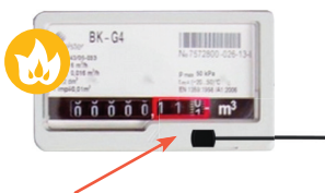
Zabudovaný magnet v plynoměru
