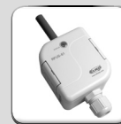
RFUS-61 1-kanalowy wielofunkcyjny aktor do załączania 1 x zwierny 16A 230V AC, obudowa IP65
